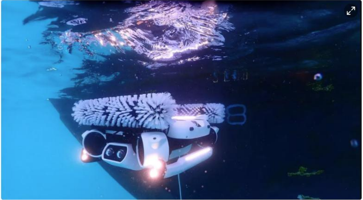
Hullbot水下机器人，解决船体生物附着问题，有助改善燃油效率，降低营运成本。（取自SG Mark官网）
